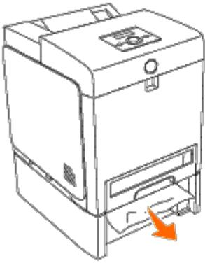
□□□ ボタン（右側）を押してフロントカバーを開き、つまった用紙を取り除いてください。次に、プリンター内部に紙の切れ端が残っていないことを確認します。
